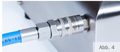
Schließen Sie den Druckluftschlauch an. (max. 6 bar/87,02 psi) (Abb. 5)
